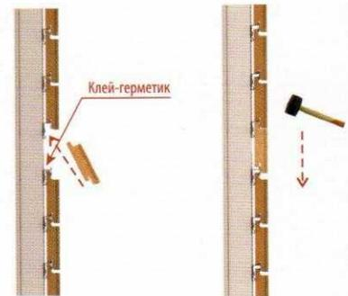
В процессе эксплуатации фасада клинкерную плитку "ФЕНИКС КЛИНКЕР" можно заменить в случае ремонта или технической необходимости (проводка коммуникаций, кабелей и пр.). Фасад демонтируется исключительно в нужном месте! Ремонтная или сменная плитка устанавливается обычным способом (ДЕЙСТВИЕ 5). Последняя плитка устанавливается на клей-герметик.
